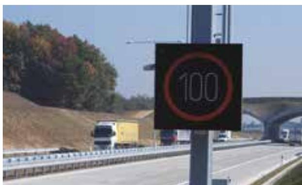
Grâce à ces panneaux nous pouvons obtenir 16 niveaux d'intensité lumineuse, selon la lumière environnante. L'intensité de luminosité est réglée et commandée automatiquement, selon des conditions de jour et de nuit.
